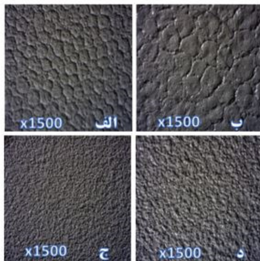
شکل ۱. تصویر میکروسکوپ نوری از سطح نوار آند: الف) ۲ ساعت، ب) ۴ ساعت، ج) ۶ ساعت، د) ۸ ساعت
